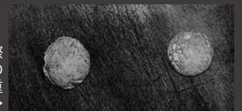
〔写真⑦〕大津家で実際に製造された大砲の弾。直径約6.5cm、重量約800g →
