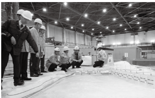
↑水理模型で「九州北部豪雨時」を再現して実験
