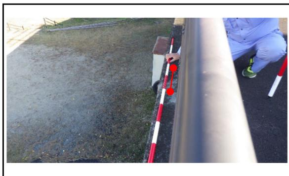
Point⑧ 測量ピンを打ち、2点間の距離を測定
