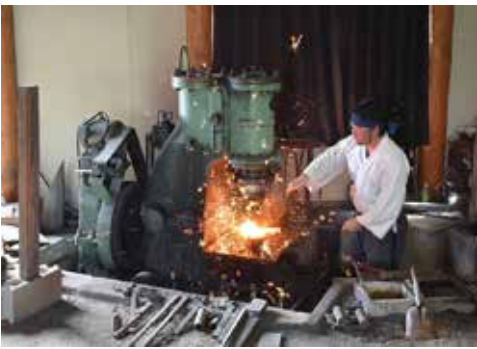
(写真上) 鉄を加工するための炉の温度は1,300度を超え、黄金色の炎が躍る
