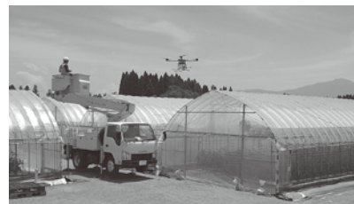
ドローンによる遮熱剤散布
