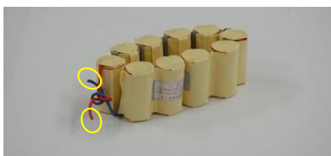
(固定されていない電池パック)
